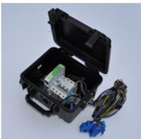
**Abbildung 1:** Messkoffer für die Analyse von Stromlastgängen im Rahmen eines Energieaudits
