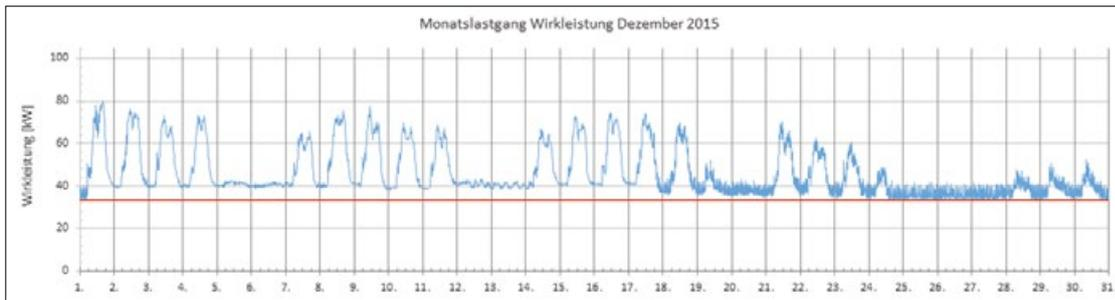
**Abbildung 2:** Stromlastgang eines Bürogebäudes mit deutlichem Grundlastanteil. Der Stromlastgang wird im Rahmen des Energieaudits ausgewertet.
