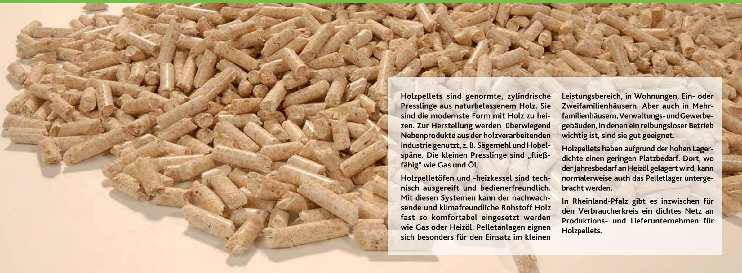
Holzpellets sind genormte, zylindrische Presslinge aus naturbelassenem Holz. Sie sind die modernste Form mit Holz zu heizen. Zur Herstellung werden überwiegend Nebenprodukte aus der Holzverarbeitenden Industrie genutzt, z. B. Sägemehl und Hobelspäne. Die kleinen Presslinge sind „fließfähig“ wie Gas und Öl.
