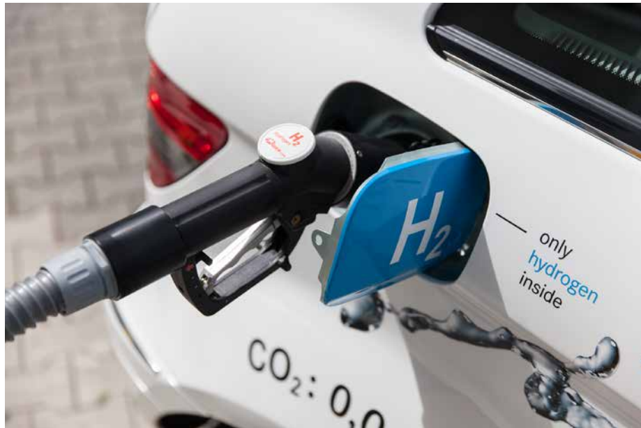
Das Tanken eines Brennstoffzellenfahrzeugs dauert nur wenige Minuten (Foto: H2 MOBILITY/Krumbholz)
