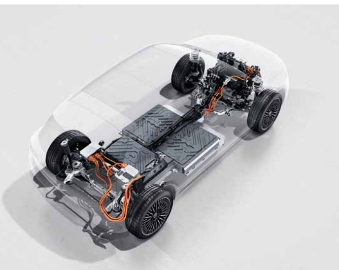
Die Traktionsbatterie von BEV befindet sich in der Regel im Fahrzeugboden. Es gibt Fahrzeuge mit Front-, Heck- oder Allradantrieb (Quelle: Daimler AG)
