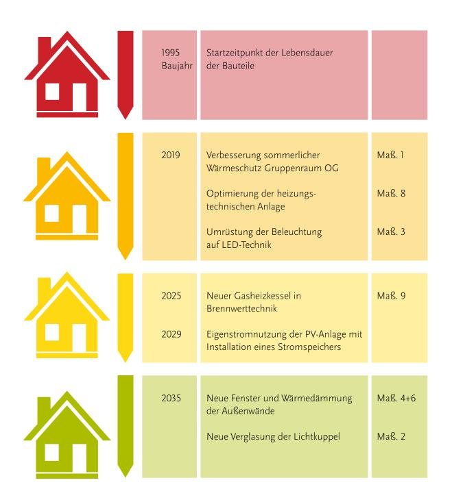
Die Erneuerung des Wärmeerzeugers erfolgt nach 30-jährigem Betrieb des vorhandenen Kessels, der spätestens dann üblicherweise ausgetauscht werden muss. Es wird ein neuer Gas-Brennwertkessel als die investiv kostengünstigste Ersatzmaßnahme vorgesehen.
